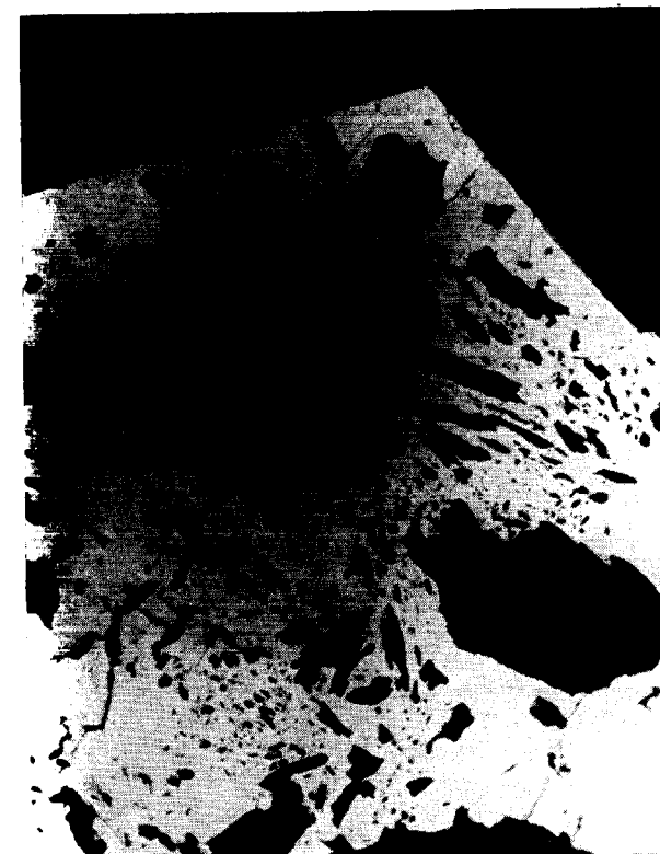
Fotomic. 13.—P-1302. Textura poiquilítica de arsenopirita II que engloba cristales alargados, según el eje c , de actinolita-tremolita. Probeta pulida, \times 70 .
