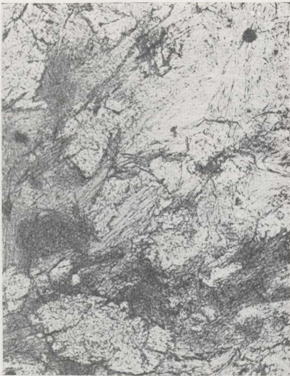
Fotomic. 15.—T-3278. Cristales de actinolita, muy pleocroica, englobando secciones de epidota a la que sustituyen parcialmente. Nícoles paralelos, \times 90 .
