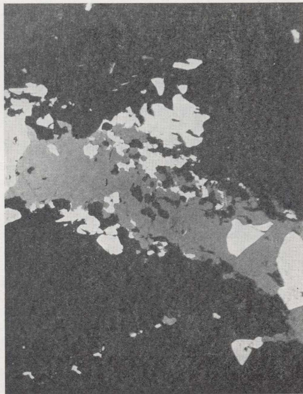
Fotomic. 18.—P-1307. Fractura rellena por calcopirita II y blenda II. Probeta pulida, \times 180 .
