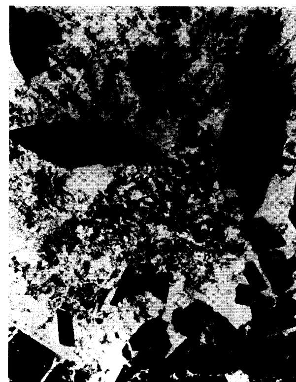
Fotomic. 12.—T-3128. Típicos cristales idiomorfos de arsenopirita II. Nícoles paralelos, \times 16 .
