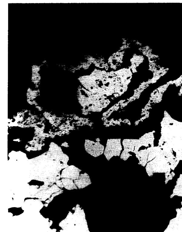
Fotomic. 2.—P-1313. Pirita I singenética, deformada posiblemente durante el proceso de diagénesis, y pirita II hidrotermal. Probeta pulida, \times 180 .
