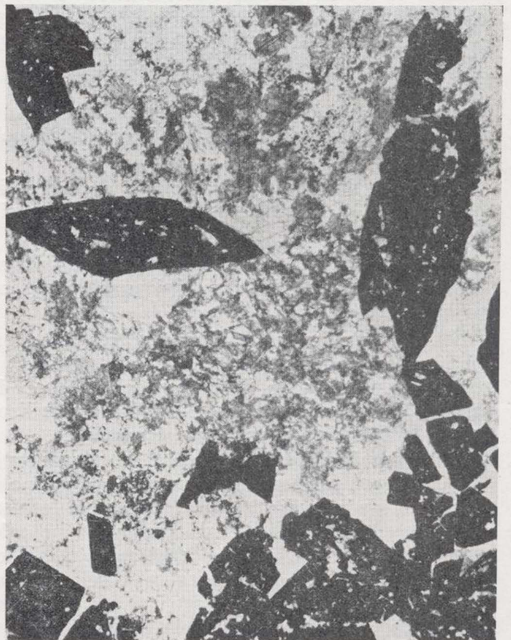
Fotomic. 12.—T-3128. Típicos cristales idiomorfos de arsenopirita II. Nícoles paralelos, \times 16 .
