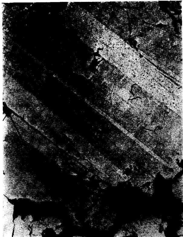
Fotomic. 9.—P-1333. Magnetita zonada. Ataque con CIH durante cuatro minutos. Probeta pulida, \times 300 .
