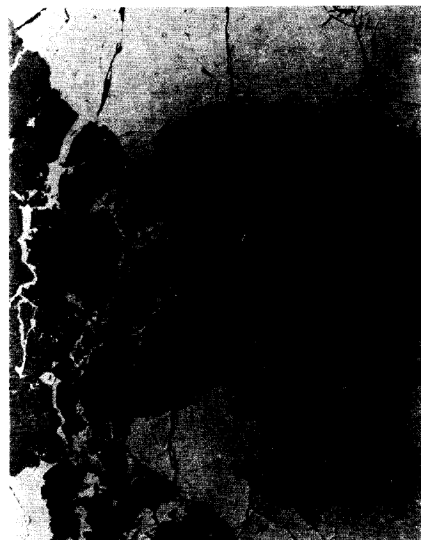
Fotomic. 10.—P-1315. Magnetita II con fracturas que son rellenadas por pirrotina I, de buen tamaño de grano y posterior, Probeta pulida, \times 70 .
